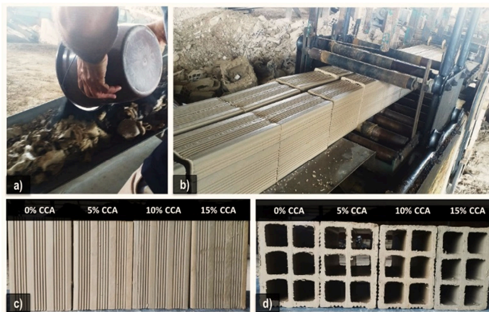
Figura 18: a) Mistura dos materiais; b) processo de fabricação e obtenção dos blocos; c) e d) aspecto visual de um exemplar de cada classe de blocos formuladas, no estado cru.
