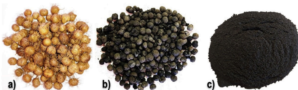
Figura 16: a) Caroços gerados no processo de fabricação do açaí; b) resíduo gerado através do procedimento de queima; c) cinza moídas.
